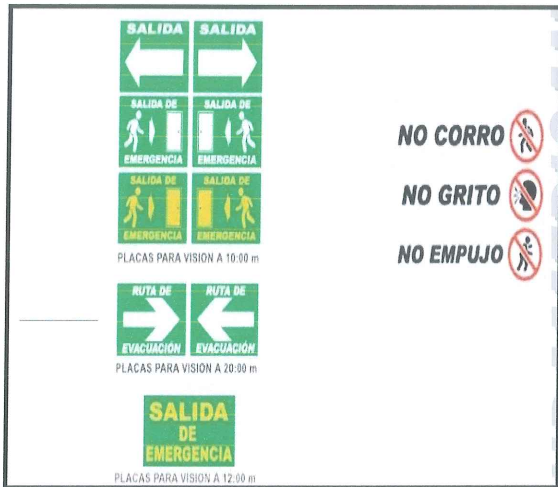
Fig. 4. Señalización para evacuación. Fuente: (Torre, 2015)
